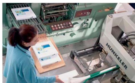
Automatisches Einhängen der Buchblocks in die fertigen Buchdecken
