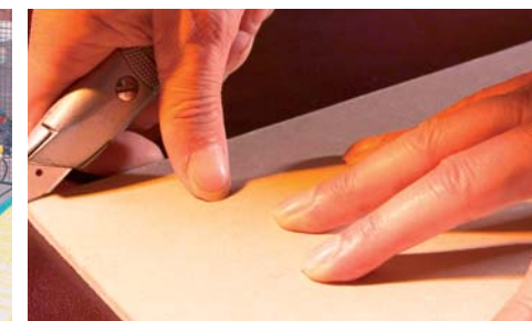
Zuschneiden hochwertiger Ledermaterialien mit Hilfe von Schablonen Cutting high-quality leather materials using templates Découpe de cuirs de très haute qualité à l'aide de pochoirs
