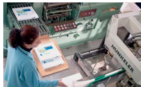
Automatisches Einhängen der Buchblocks in die fertigen Buchdecken Inner books are automatically inserted into the ready-made book covers Application automatique des couvertures finies sur les corps d'ouvrages
