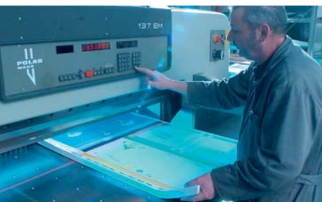
Schneiden der Überzüge der Alben aus Großbögen Cutting album covers from broadsheets Découpe des couvertures d'albums dans des grandes feuilles
