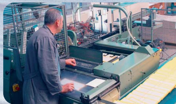
Herstellung der Buchdecken Fabrication des couvertures de livres Production of book covers
