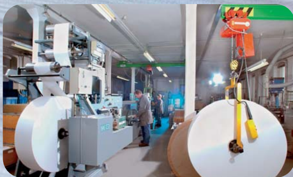
Fertigungsstraße für Albenblocks Chaîne de fabrication des corps d'albums Production line for inner albums
