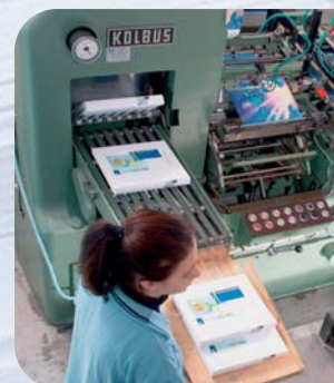
Automatisches Einhängen der Buchblocks in die fertigen Buchdecken
