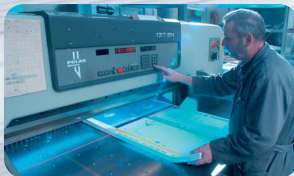
Schneiden der Überzüge der Alben aus Großbögen
